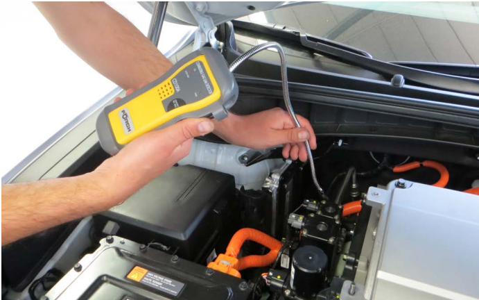
Abb. 9 Die Eingangsprüfung eines Fahrzeugs sollte mit einem H 2 -Handsensor durchgeführt werden.
