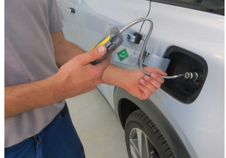
Abb. 12 Nach Arbeiten an Tanksystemen werden Lecktester eingesetzt.
